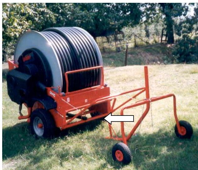
**9.** Durante l'irrigazione il Leader 50 riavvolge completamente il tubo. Il contatto con il carrello portairrigatore provoca la fine dell'irrigazione.
