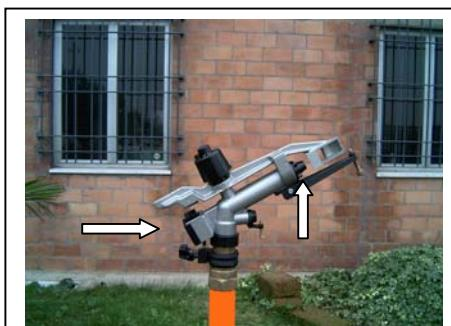
**8.** Durante l'irrigazione è possibile regolare l'intensità di pioggia utilizzando la valvola posta sulla turbina. Chiudendo la valvola la velocità di riavvolgimento del tubo aumenta. Aprendo la valvola la velocità diminuisce.
